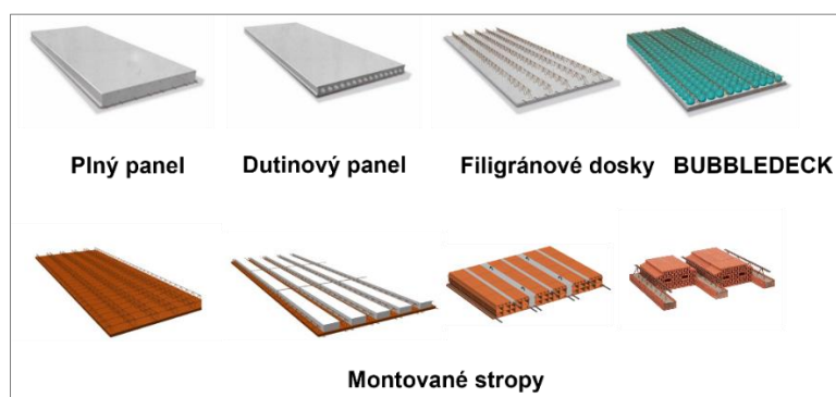
Obr. 4 Allplan Precast – Stropní systémy
