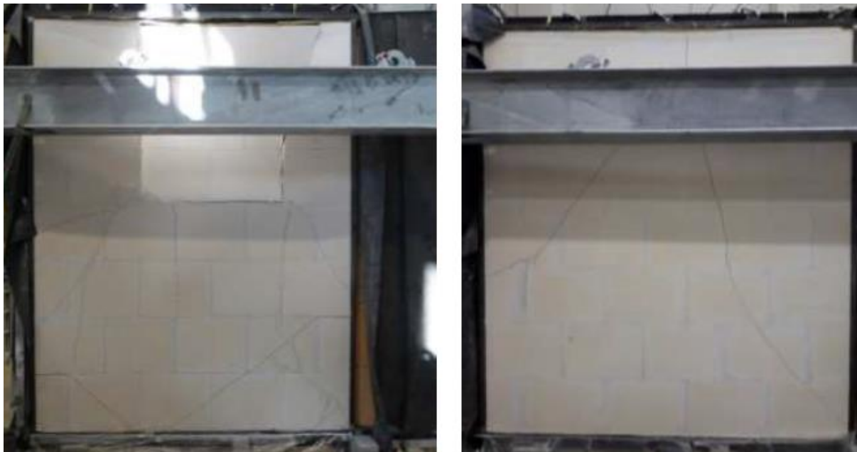
Obr. 15 Porušení vzorků; a) vzorek I, b) vzorek II
