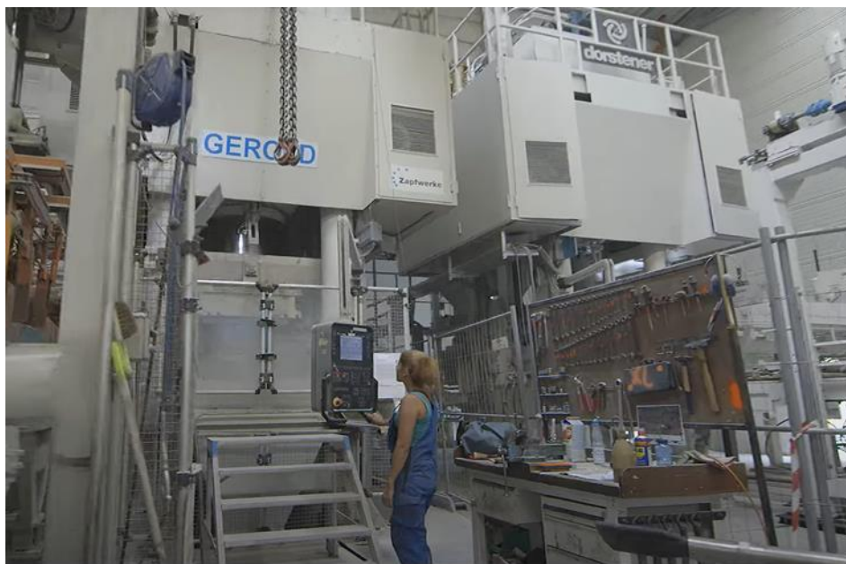
Obr. 4 Moderní lis Dorstener pro výrobu formátů KS-QUADRO pod tlakem 2500 tun
