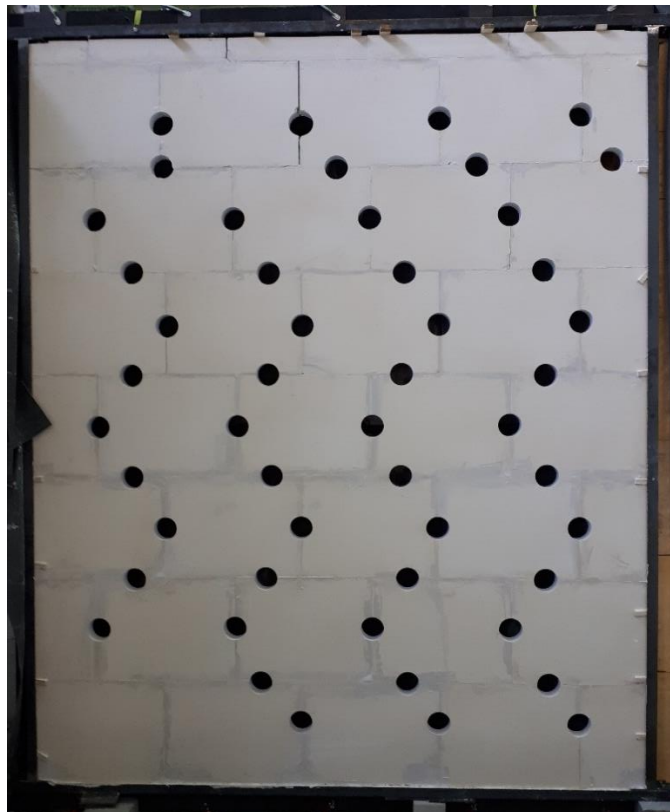
Obr. 22 Experimentální stěna vyzděná v areálu AdMaS pro ověření způsobu zdění s provedenými jádrovými odvrtý ze zdících bloků MULTIGIPS M80
