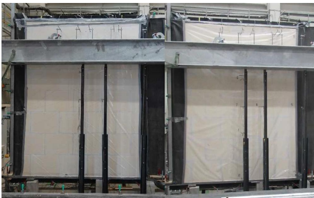
Obr. 8 Pohled na zkušební vzorky s osazenou vakuovací membránou zkušební vzorek I (vlevo), b) zkušební vzorek II (vpravo)
