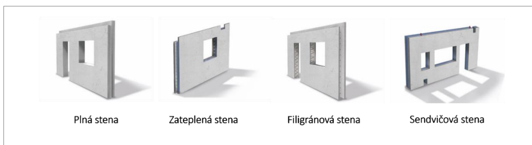
Obr. 3 Allplan Precast – Stěnové konstrukce
