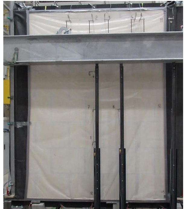
Obr. 10 Poloha bodů měření posunu/deformace příčky a reálné provedení – shodné pro Vzorek I i II, a) schéma měřených bodů, b) pohled na stěnu s vyznačenými měřnými body
