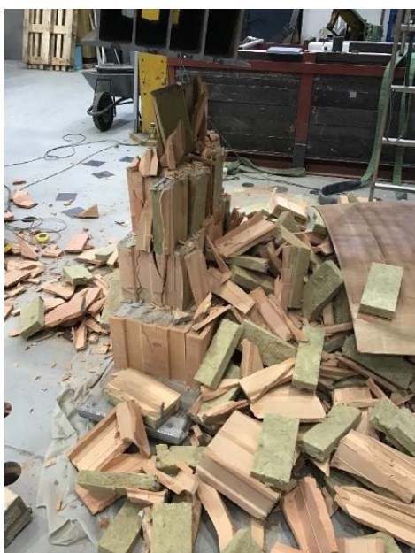
Obr. 1 Vzorek po destrukci – spodní řada neporušena
