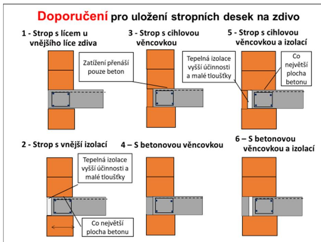
Obr. 4 Schéma doporučených možností uložení betonové stropní konstrukce na zdivo
