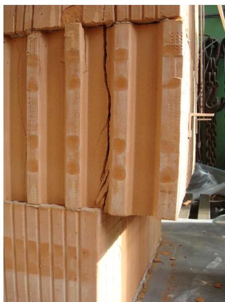
Obr. 8 Poškození první řady
