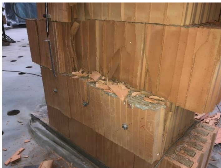
Obr. 9 Hmoždinky udrží první vrstvu i po odpadání dalších
